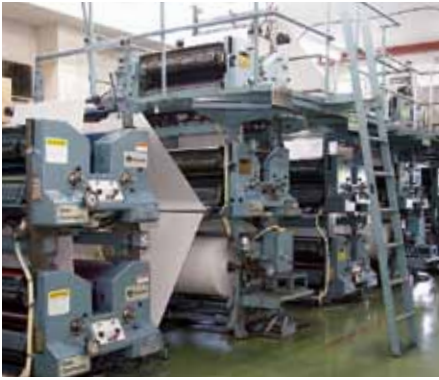
最大でカラー 8 頁+モノクロ 4 頁建の印刷が可能な輪転機
