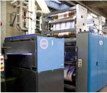
LED-UV 乾燥装置を搭載したオフセット輪転機
